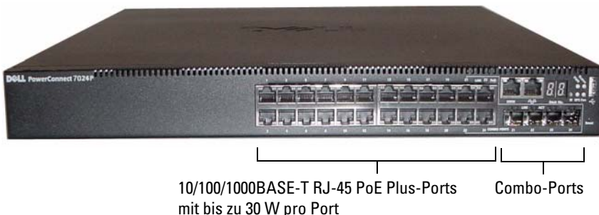
Abbildung 1-2. PowerConnect 7024P mit 24 10/100/1000BASE-T PoE Plus-Ports
