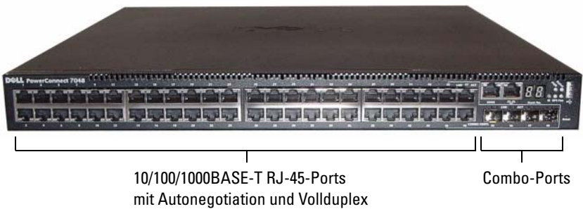
Abbildung 1-4. PowerConnect 7048 mit 48 10/100/1000BASE-T-Ports
