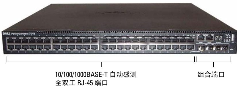
图 1-4. PowerConnect 7048, 具有 48 个 10/100/1000BASE-T 端口
